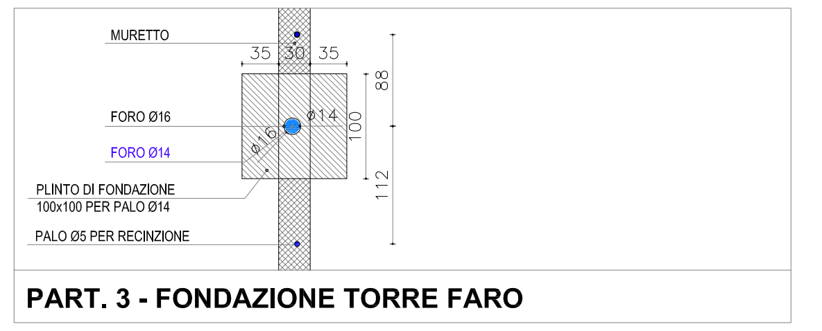
PART. 3 - FONDAZIONE TORRE FARO
